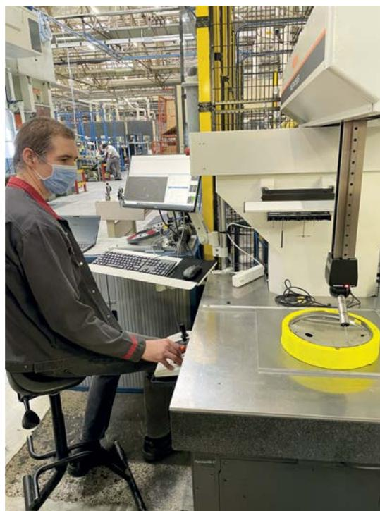
**3. MACHINE 3D QUI MESURE LES DIMENSIONS DU COUVERCLE EN LE PALPANT**
